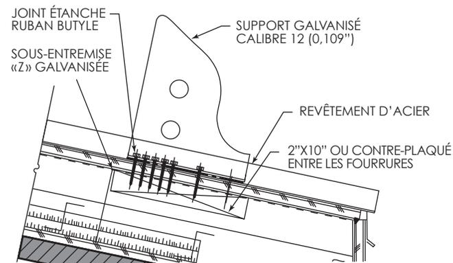
Figure 2 : Arrêt de neige à barreaux avec sous-structure de bois
