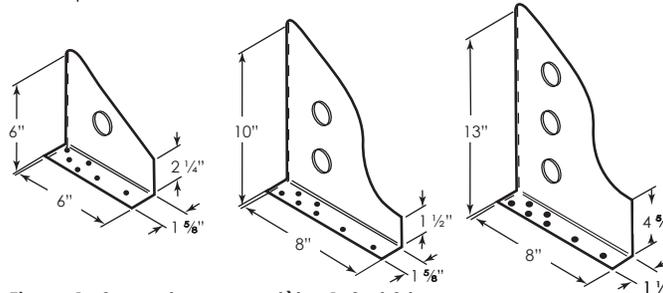
Figure 1 : Supports pour modèles 1, 2 et 3 trous
